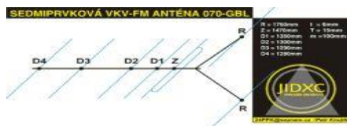
Obr č.3 : Konstrukční náčrt sedmiprvku "070 GBL Supersonic"
