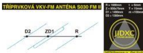
Obr č.2 : Konstrukční náčrt tříprvku "030 FM II"
